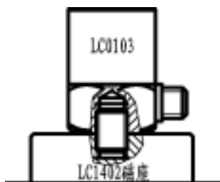
图 6 磁力安装座安装示意图
